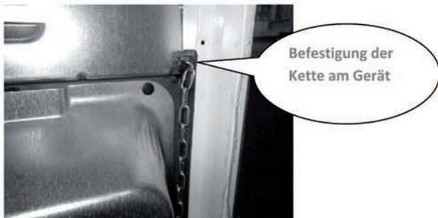
Die erste Kette an der Rückseite des Gerätes links an vorhandener Schraube befestigen (Schraube lösen, Kette einlegen, Schraube wieder befestigen).
