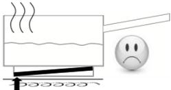
Ferromagnetisches Element wurde schlecht eingebaut
