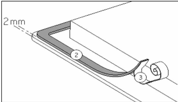
Die Dichtung (2) nach Abnehmen der Schutzfolie (3) mit 2 mm Abstand der Außenkante des Glases aufkleben.
