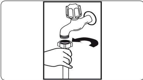
**! WARNUNG:** Mitgelieferten Zulaufschlauch verwenden. Eventuell vorhandenen Zulaufschlauch eines Altgeräts NICHT verwenden.
