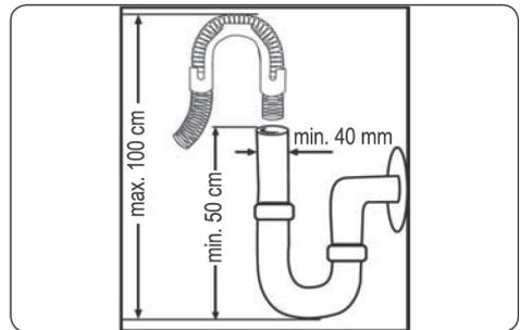
**! HINWEIS:** Bei einer Länge des Ablaufschlauches von mehr als 4 m ist keine ausreichende Reinigungsleistung mehr gegeben.
