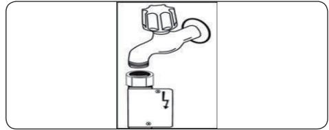
**! WARNUNG:** Einige Modelle werden mit Aquastop-System geliefert. Dieses nicht beschädigen, knicken oder verdrehen.
