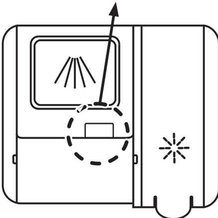
Für den Hauptwaschgang Geschirreiniger in die Geschirreinigerkammer (A) geben. Für ein besseres Reinigungsergebnis, insbesondere bei stark verschmutzten Gegenständen, geben Sie zusätzlich eine kleine Menge Geschirreiniger auf die Innenseite der Spülraumtür. Diese zusätzliche Menge Geschirreiniger ist für den Vorwaschzyklus. Entnehmen Sie der Tabelle "Übersicht der Spülprogramme", welche Programme einen Vorwaschzyklus beinhalten.
