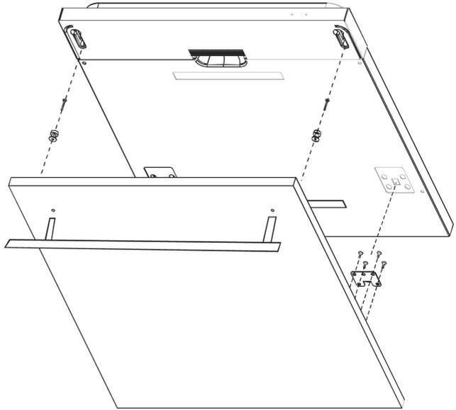
Diese 4 kurzen Schrauben entfernen...
