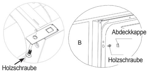
**Abbildung 2b: Schrankbefestigung**
