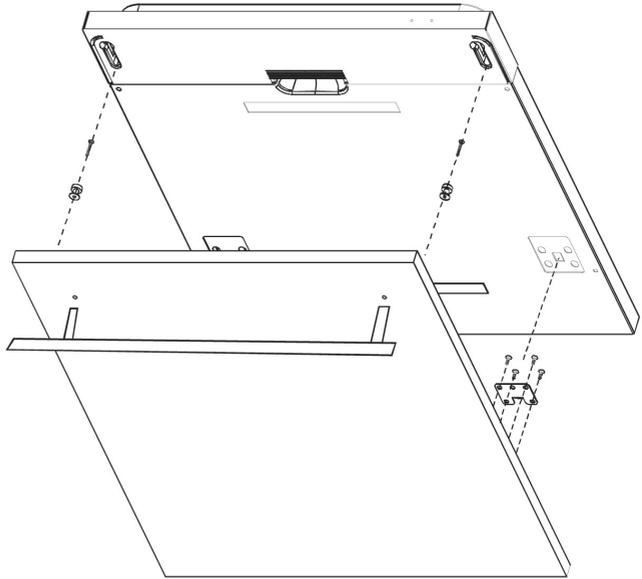
Diese 4 kurzen Schrauben entfernen...
