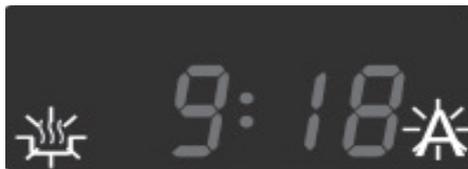
Bei Erreichen des eingestellten Gar-Endes ertönt ein akustisches Signal und das Symbol „**A**“ blinkt im Display.
