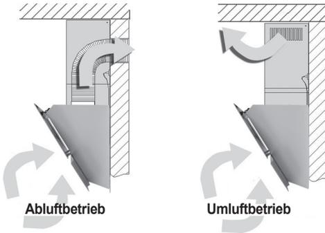
Bei **Abluftbetrieb (empfohlen)** wird der Wrasen über ein Abluftsystem mit Mauerkasten ins Freie geführt.
