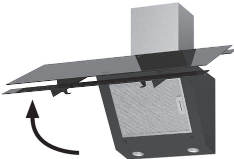
Der Metallfettfilter ist jetzt sichtbar und zugänglich.
