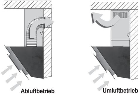
Bei **Abluftbetrieb** wird der Wrasen über ein Abluftsystem mit Mauerkasten ins Freie geführt.
