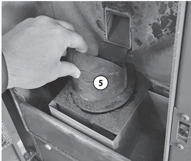
Après nettoyage, il ne doit plus rester de résidus de cendres dans le pot brûleur. Les résidus brûlés et incrustés doivent être également éliminés le mieux possible. Les trous du pot brûleur ne doivent pas être obturés ou bouchés.
