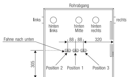
Werkseitig ist der Abgasstutzen hinten, mittig, der Abgastemperaturwächter in Position 1 montiert.
